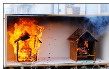
火災時を想定したデモンストレーションの様子。 左の標準的な木製品仕様に対し、右が準不燃処理を施したものの。 ※ 実際の認定品とは仕様が異なります。
